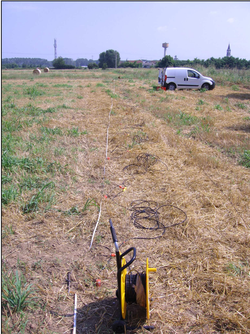
Figura 3: Vista dello stendimento MASW.
