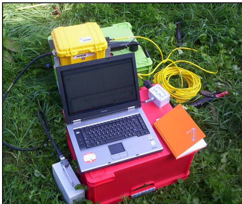
Figura 2: Strumentazione utilizzata per la prova MASW.
